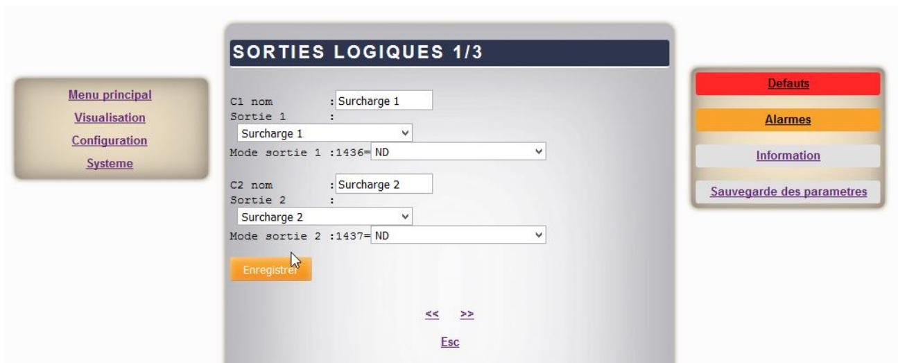
FIGURE 73 - RÉGLAGE DES SORTIES LOGIQUES POUR UN CONSOMMATEUR NON ESSENTIEL
