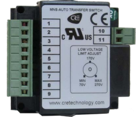
MNS MODULE REAR FACE
