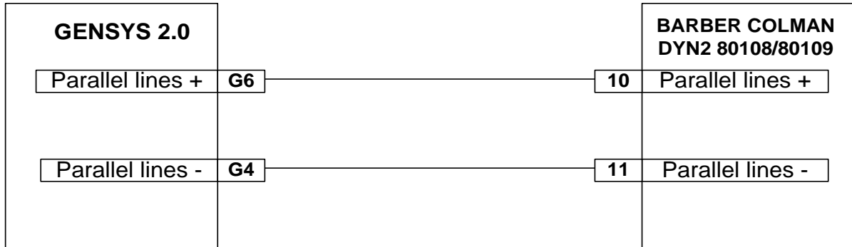
FIGURE 55 - CÂBLAGE DES LIGNES PARALLÈLES
