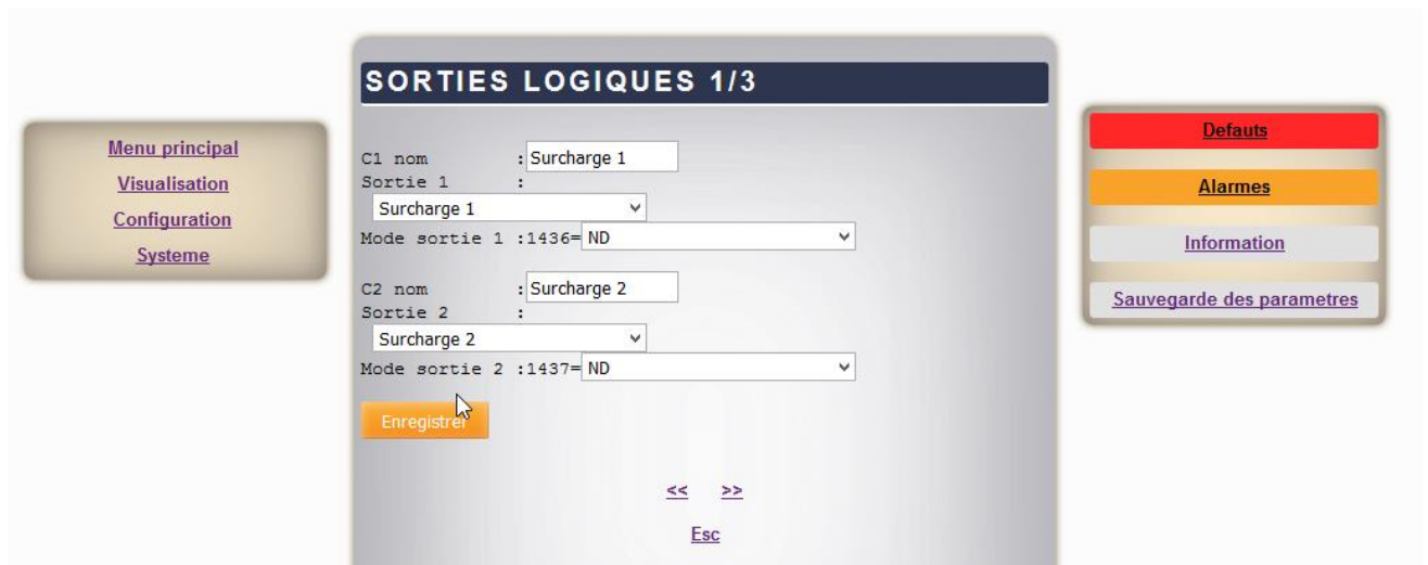
FIGURE 73 - RÉGLAGE DES SORTIES LOGIQUES POUR UN CONSOMMATEUR NON ESSENTIEL
