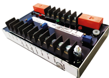
VISTA LATERAL DE LA TARJETA DV2
