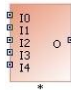
FIGURA 19: OPERADOR DE MULTIPLICACIÓN CON 5 ENTRADAS
