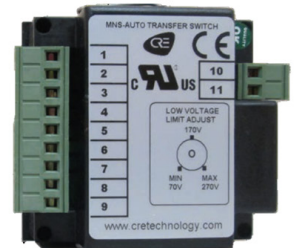
MNS MODULE REAR FACE
