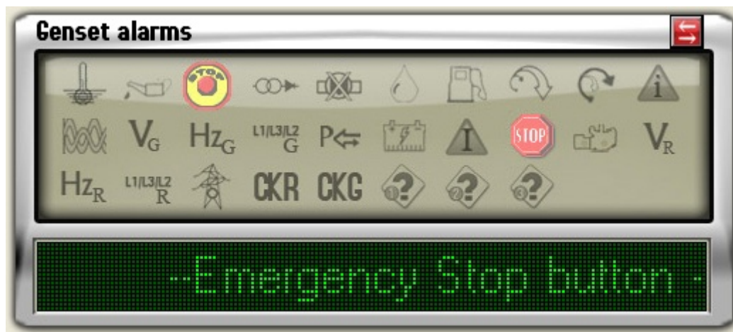
Figure 9: Fenêtre des alarmes du groupe
